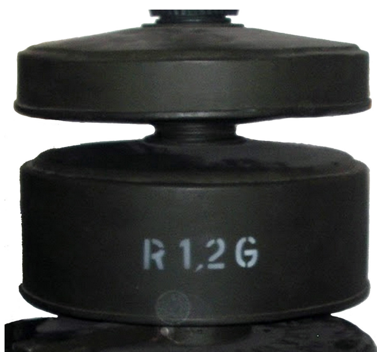
Cartouches filtrantes anti gaz. Hors période d'alerte un tube de bakélite remplaçait les filtres anti gaz.
